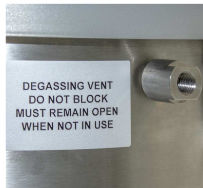
発生ガス排気弁
