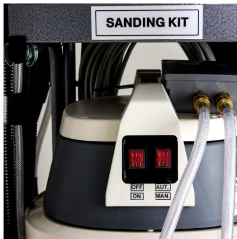
エアツール連動掃除機動作
